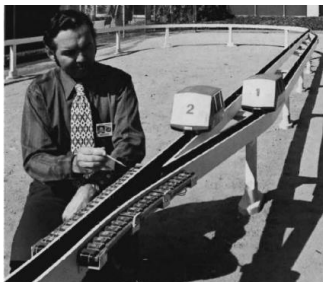
Rys. 21. Instalacja przełączników elektromagnetycznych systemu PRT firmy Aerospace Corporation z roku 1972 [7]
