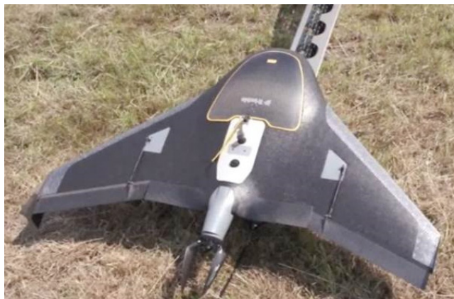
Rysunek 1 Trimble UX5 na wyrzutni przed startem [źródło: opracowanie własne]
