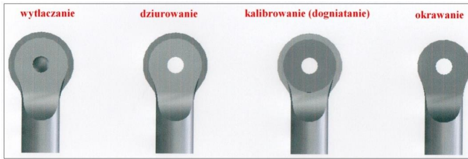
Rys. 17. Fazy obróbki końcówek stabilizatorów samochodowych Fig. 17. Machining operation of ends the stabilizer bar
