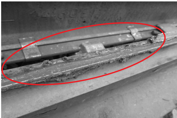
Rys. 3. Uszkodzenia iglic w postaci wykruszenia materiału: a) iglica rozjazdu 3, b) iglica rozjazdu 1 [fot. M. Czarnecki]
