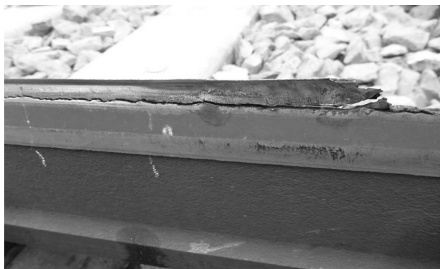
Rys. 4. Propagujące pęknięcie obok wykruszenia materiału w iglicy [fot. M. Czarnecki]
