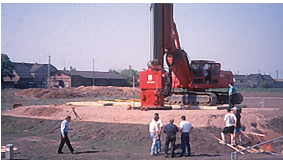
Fot. 6 a, b. DyStaFit: maszyna do symulacji jazdy pociągów: płyta o średnicy 2,5 m i masie 5 ton, częstotliwość do 39,2 Hz, symulowana prędkość jazdy pociągów ICE v = 300 km/h, Projekt „Rathenow” i „Groebers”; Niemcy Fot. Huesker Synthetic GmbH.
