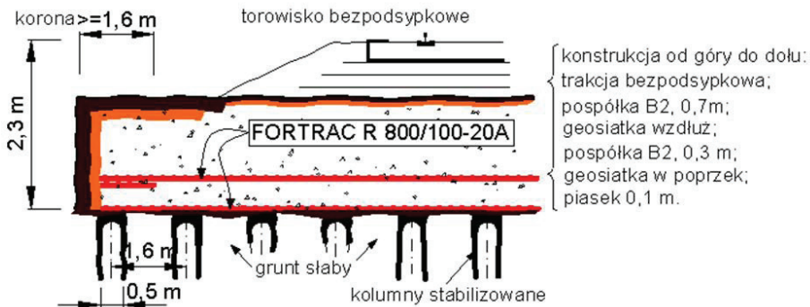
Rys. 12. Typowy przekrój torowiska; Projekt „Rathenow”; Niemcy
