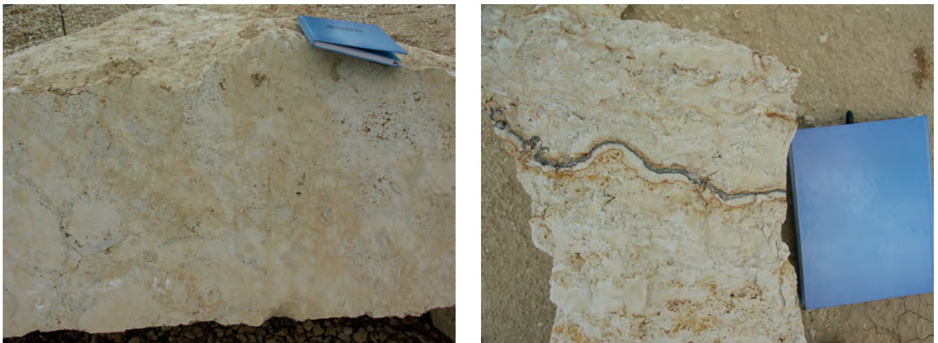
Rys. 2 Wapienie typu trawertynu z lokalnie widoczną obecnością kawern (zdjęcie po lewej) oraz nagromadzeniami związków żelaza i manganu i kalcytu w pustkach przestrzeniach, które powstały po wylugowaniu węglanu wapnia (zdjęcie po prawej stronie)
