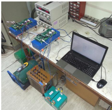
Rys. 7. Stanowisko testowe do badań przetwornic DC/DC
