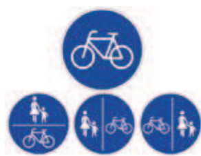
Rys. 2. Oznakowanie pionowe dróg rowerowych. Na górze znak 237, poniżej 241 w możliwych konfiguracjach
