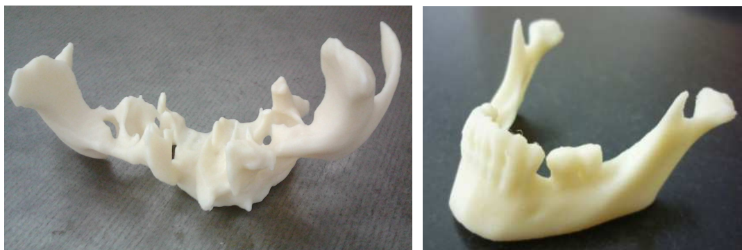
Rys. 10. Modele wykonane metodą FDM [1]
