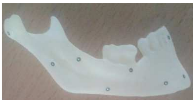
Rys. 12. Modele wykonane metodą PolyJet [6]
