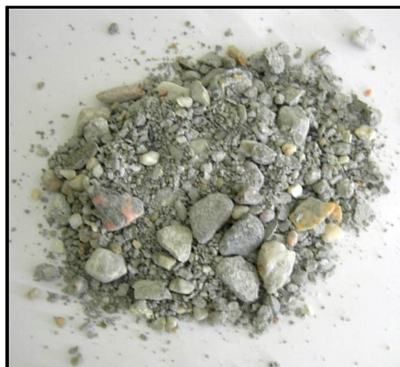
Rys. 5. Beton na spoiwie CEM I+40%PF+GO po 300 cyklach zamrażania i odmrażania Fig. 5. Sample CEM+40% PF+GO after 300 cycles of freezing and thawing
