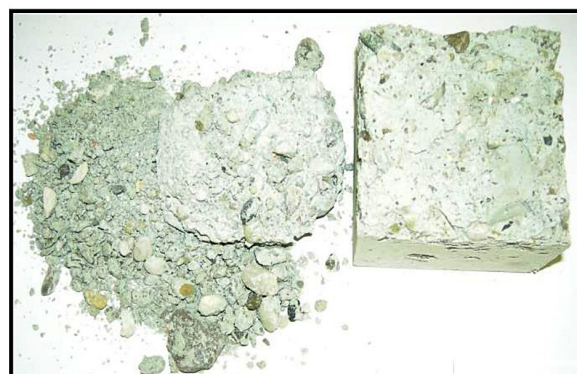
Rys. 6. Beton na spoiwie CEM III/B+GO po 300 cyklach zamrażania i odmrażania Fig. 6. Sample CEM III/B+GO after 300 cycles of freezing and thawing
