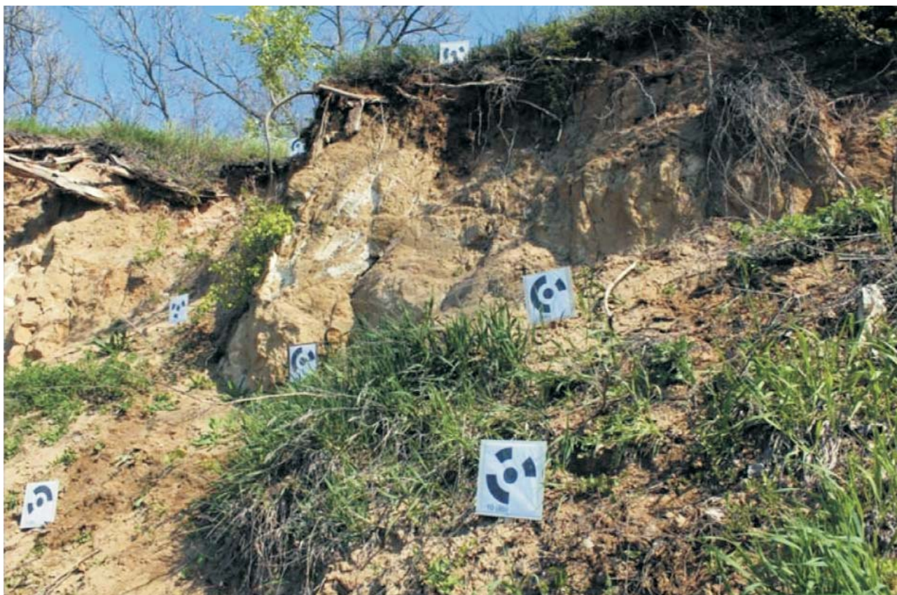
Ryc. 2. Osnowa fotogrametryczna na fragmencie skarpy w Płocku. Obie fot. M. Przyłucka Fig. 2. Photogrammetric network on a part of the slope in Płock. Both photos by M. Przyłucka
