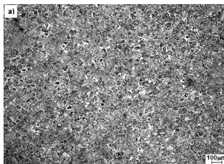
Rys. 3. Mikrostruktura stopu ZnAl10 zmodyfikowana dodatkiem 25ppm Ti, (a) – pow. 50x, trawione Nitałem, (b) – pow.100x, trawione Nitałem
