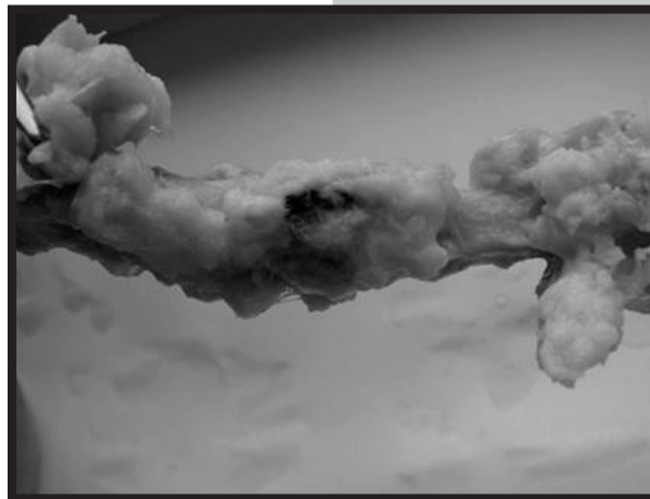
RYS. 18. Kość udowa królika z wszczepionym cementem modyfikowanym węglem szklistym [26]. FIG. 18. The rabbit femur with implanted cement modified with glassy carbon [26].
