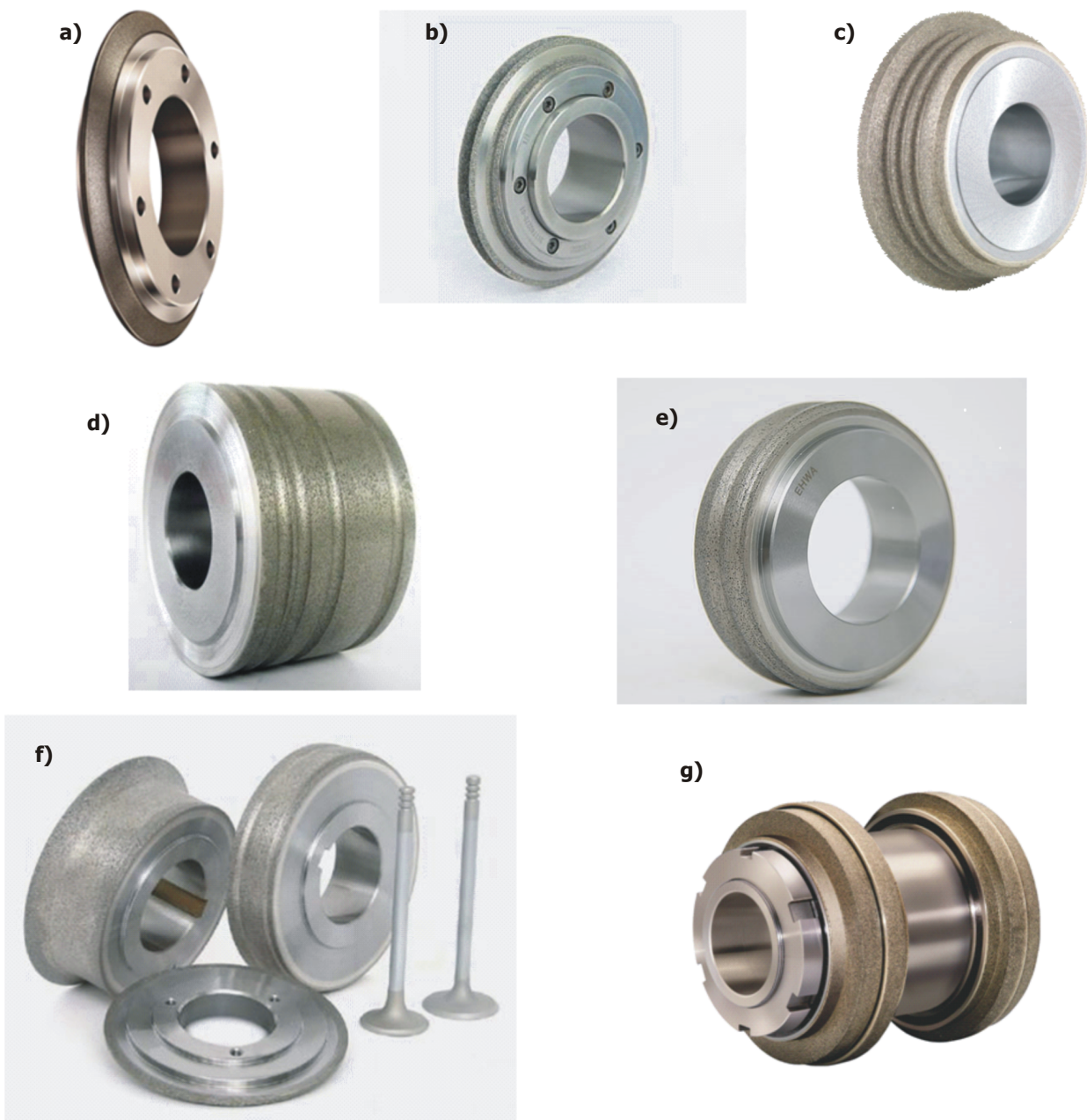
Rys. 5. Przykłady diamentowych obciągaczy wirujących [7]: a) obciągacz wąski do profilowego obciągania ściernic na szlifierkach CNC, b) obciągacz wąski do obciągania ściernic do kół zębatach, c) obciągacz szeroki do obciągania ściernic do skośnego szlifowania wałków, d) i e) obciągacze szerokie do obciągania ściernic do łożysk, f) zespół obciągaczy wirujących do obciągania ściernic do zaworów silnikowych, g) zespół obciągaczy wirujących do obciągania ściernic do szlifowania kształtowego wałków wielostopniowych
