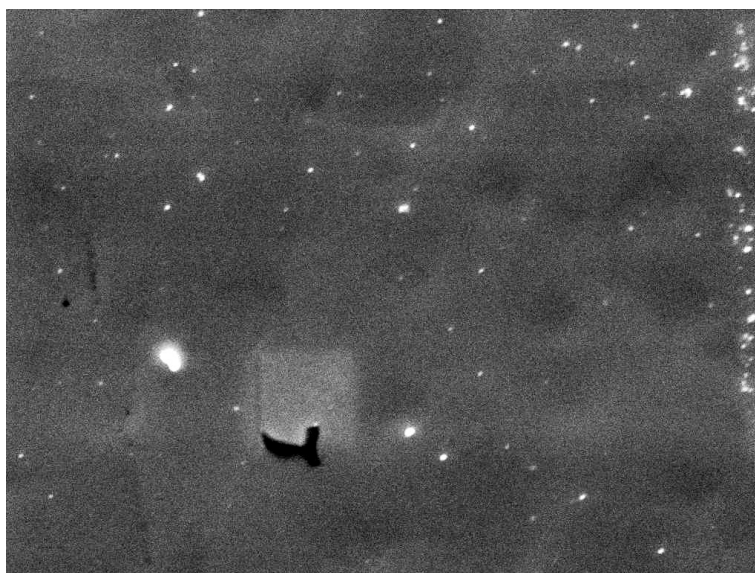
Rys. 1. Mikrofotografia SEM wypolerowanej ceramiki PLZT 7/65/35
