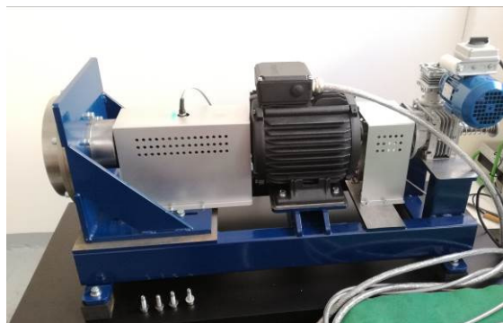
Rys. 3. Stanowisko montażowe hamowni 15 kW
