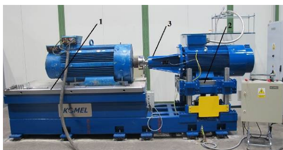
Rys. 1. Stanowisko montażowe hamowni 200 kW
