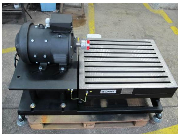
Rys. 2. Stanowisko montażowe hamowni 9 kW
