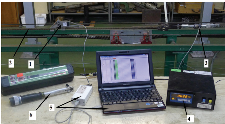
Rys. 2. Kalibracja czujnika siły (1 – kalibrowany czujnik Henning LS, 2 – linę, 3 – czujnik siły CL15, 4 – rejestrator siły, 5 – system rejestracji wartości siły PIP_02, 6 – klucz dynamometryczny)
