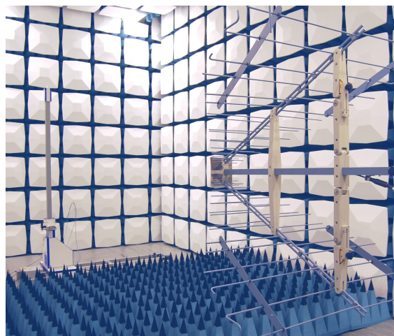
Rys. 2. Komora SAC 3 m wraz z zestawem do kalibracji jednorodnego pola elektrycznego
