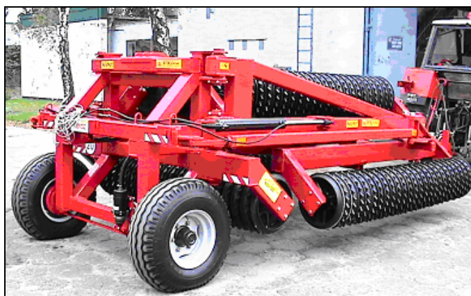
Rys. 4. Wał uprawowy o szerokości 12 m Fig. 4. Agricultural roller 12 m width
