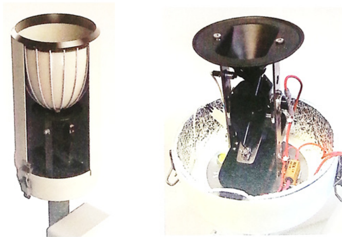
Rys. 8. Budowa deszczomierza: pokrywa (po lewej) oraz mechanizm pomiarowy (po prawej)
