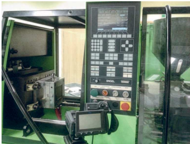
Rys. 1. Zdjęcie prezentujące ustawienie kamery termograficznej FLIR T620 w odniesieniu do obserwowanego obiektu, formy wtryskowej
