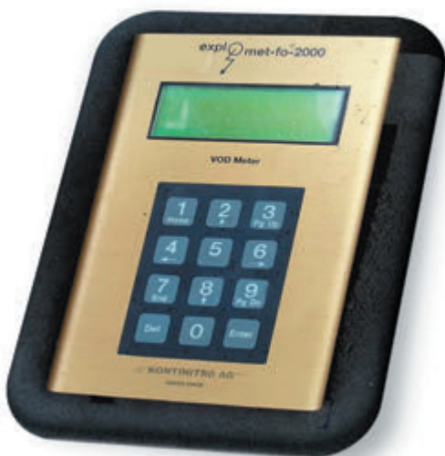
Rys. 1. Licznik do pomiaru prędkości detonacji Explomet-Fo-2000 Fig. 1. Explomet-Fo-2000 VOD counter
