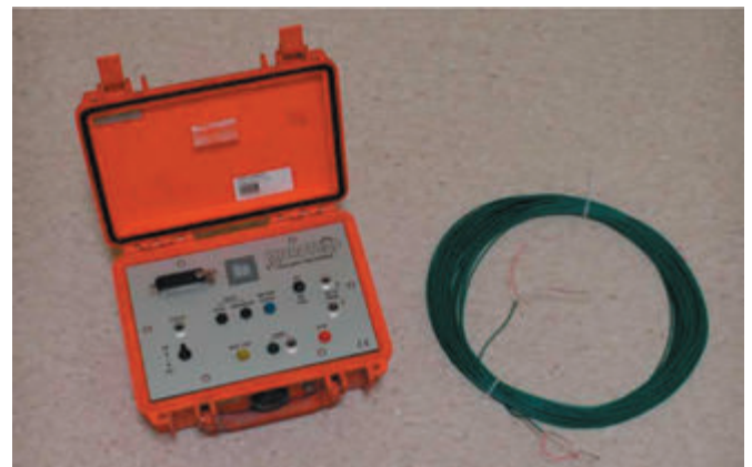
Rys. 5. Urządzenie MicroTrap (z lewej) oraz sonda pomiarowa (z prawej) Fig. 5. MicroTrap VOD recorder (left) and VOD ProbeCable (right)
