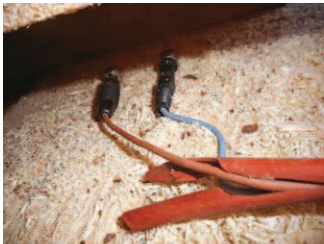
Rys. 1. Elektryczne wilgotnościomierze służące do pomiaru wilgotności suszonej tarcicy
