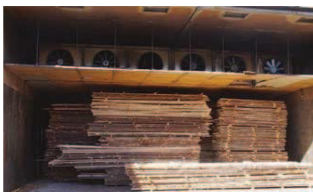
Rys. 8. Nieekonomiczne rozmieszczenie suszonego drewna w komorze suszarniczej
