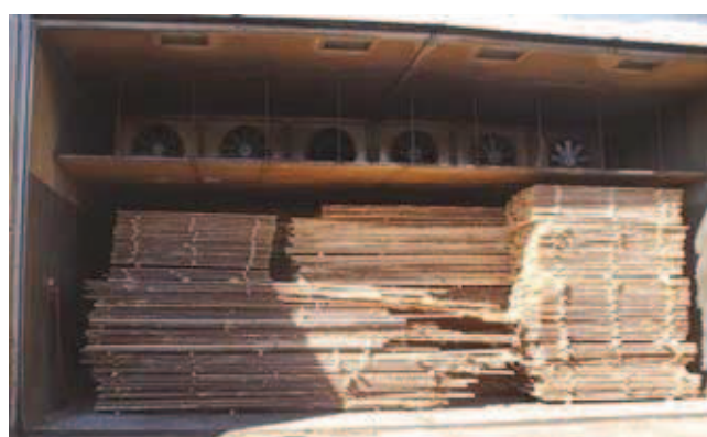
Rys. 8. Nieekonomiczne rozmieszczenie suszonego drewna w komorze suszarniczej
