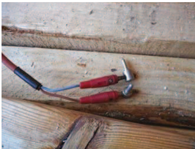
Rys. 1. Elektryczne wilgotnościomierze służące do pomiaru wilgotności suszonej tarcicy
