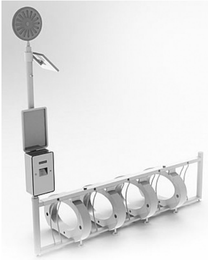
Rys. 6. Jeden moduł stacji wraz z urządzeniem sterującym i panelem słonecznym (render: W. Parylak)
