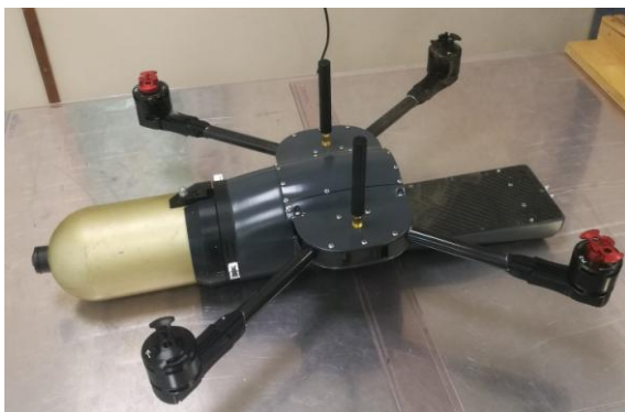
Rys. 2. Badany BSP wraz z czterema zespołami napędowymi BLDC bez śmigieł
