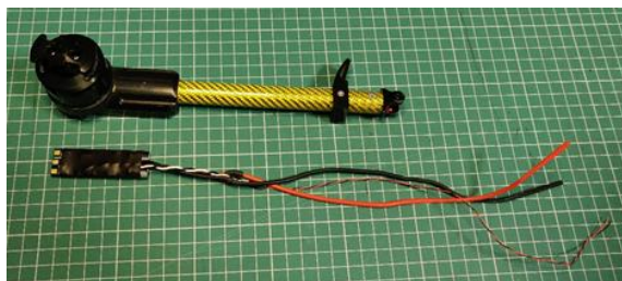
Rys. 5. Widok jednego z ramion BSP z rozmieszczeniem silnika, sterownika i przewodów doprowadzających zasilanie i sygnały sterujące
