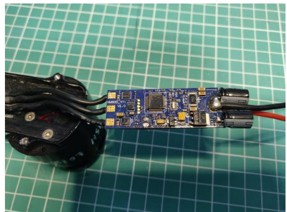
Rys. 4. Regulator silnika BLDC w badanym obiekcie
