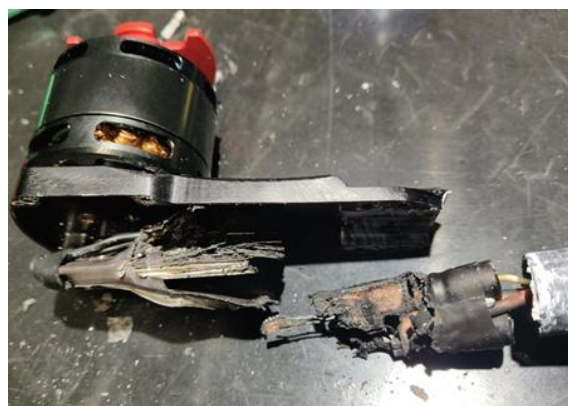
Rys. 10. Wpływ wyładowania ESD 25kV na niezabezpieczony zespół napędowy BLDC (spalony regulator)
