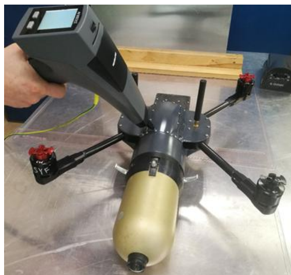
Rys. 9. Badany BSP podczas przykładania krytycznego narażenia ESD o poziomie 25 kV
