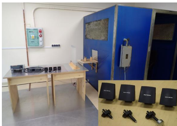
Rys. 6. Stanowisko stołowe do badań odporności na wyładowania ESD w WITU Zielonka
