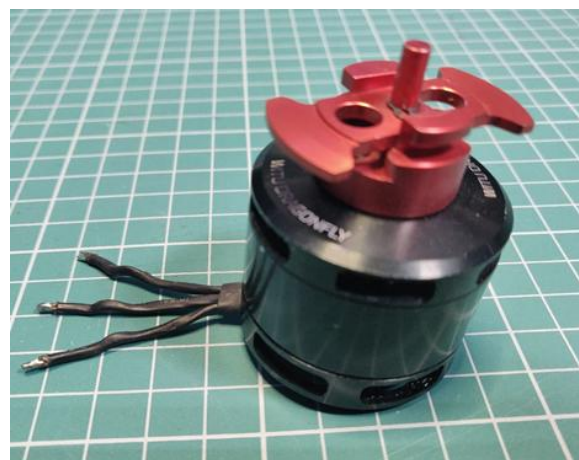
Rys. 3. Silnik BLDC zastosowany do napędu badanego BSP
