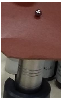
Rys. 5. Pomiar grubości skóry przy użyciu grubościomierza magnetycznego.
