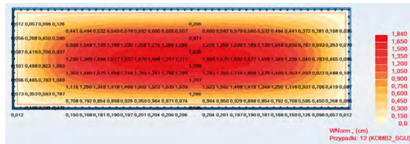
Rys. 6. Ugięcia – szyba GL 2 1430 x 4900 (66.2); ciężar własny (wsp. bez. 1,0), siła pozioma (wsp. bez. 0,2), parcie wiatru (wsp. bez. 0,9), parcie wewnętrzne (wsp. bez. 0,2), ciśnienie izochoryczne (wsp. bez. 0,2), źródło: archiwum własne autora – dokumentacja projektowa
