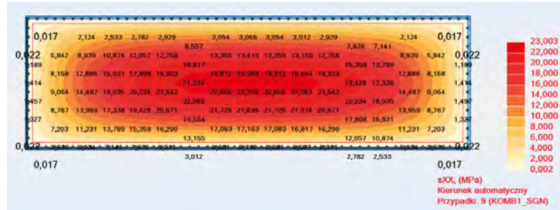
Rys. 3 Naprężenia – szyba GL 2 1430 x 4900 (66.2); kombinacja obciążeń: ciężar własny (wsp. bezp. 1,10), siła pozioma (wsp. bezp. 0,66), parcie wiatru (wsp. bezp. 1,10), ssanie wewnętrzne (wsp. bezp. 0,66), ciśnienie izochoryczne (wsp. bezp. 0,66), źródło: archiwum własne autora – dokumentacja projektowa
