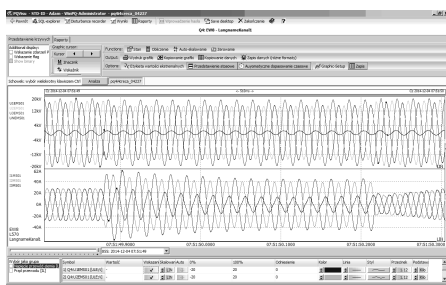
Rys. 3.3. Rejestracja oscyloskopowa zdarzenia RA z częstotliwością próbkowania 10 kHz
