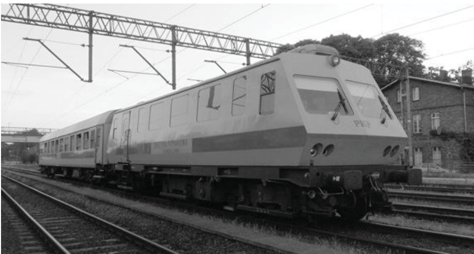
Fot. 1. Drezyna pomiarowa EM120 z wagonem socjalnym
