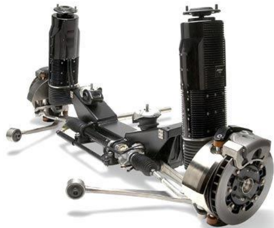
Rys. 10. Widok kolumn elektromagnetycznych przedniego zawieszenia [15]
