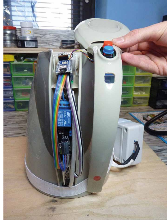
Rys. 5. Układ sterujący pracą urządzenia zainstalowany wewnątrz rączki czajnika
