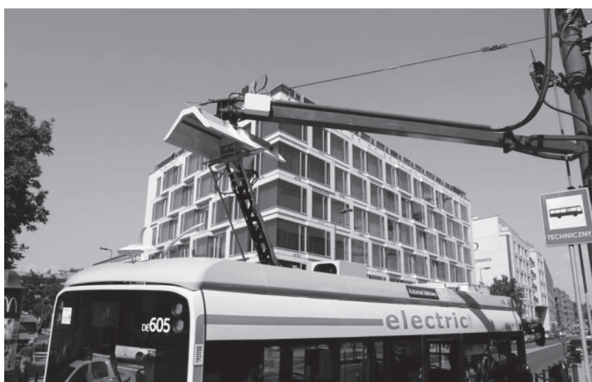
Rys. 4. Ładowanie z wykorzystaniem pantografu elektrycznego [9]
