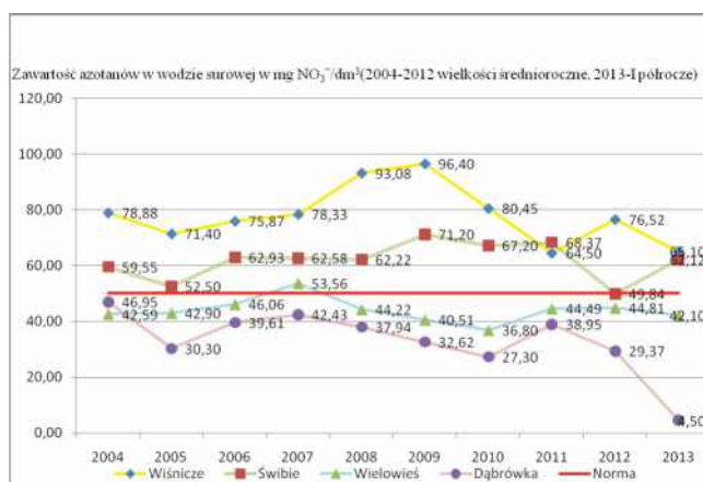
Rys. 2. Wykres zawartości azotanów w wodzie surowej w latach 2004-2013 [źródło własne] Fig. 2. Chart of content nitrate in raw water in 2004-2013 [own source]
