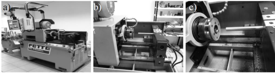
Rys. 4. Stanowisko do nagniatania gładkościowego: a) widok ogólny, b) widok układu OUPN, c) widok ogólny głowicy typ FU3 firmy FETTE
