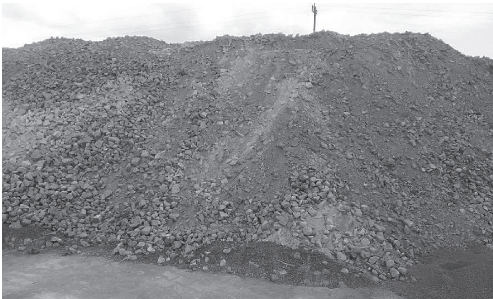
Ryc. 1. Odpad produkcyjny wstępnie przekruszony frakcji 0/63
