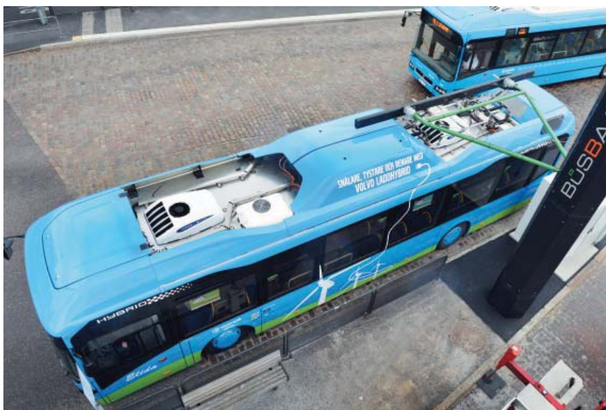
Hybrydowe autobusy Volvo typu plug-in są obecnie testowane w szwedzkich miastach
