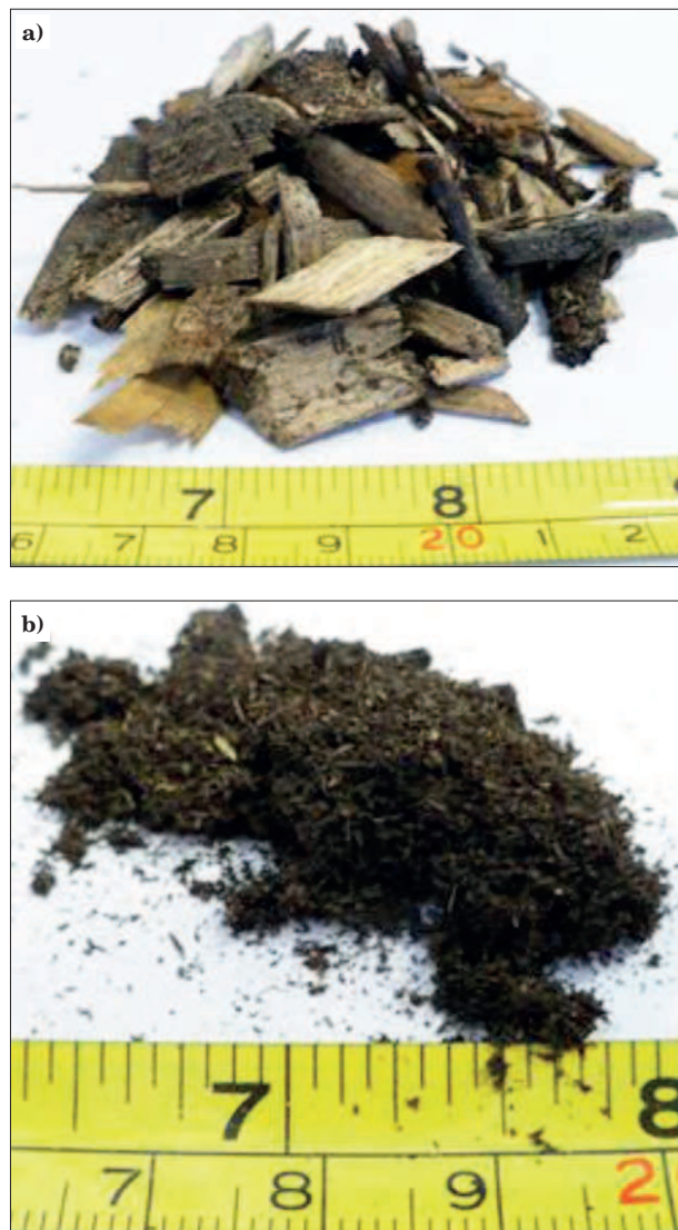
Rys. 5. Zrębki drewniane (Agro): a) przed mieleniem, b) po mieleniu [5]
