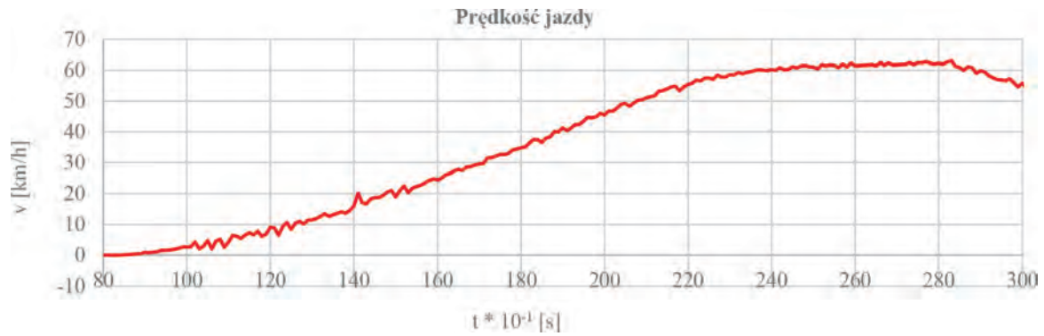
Rys. 5.5. Prędkość jazdy podjazd pod 5% wzniesienie
