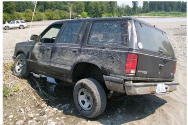
Rys. 2. Terenowy pojazd pokonujący wzniesienie. Zastosowanie sztywnego stabilizatora może doprowadzić do utraty stabilności [4].
