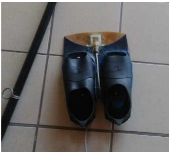
Rys. 1 Urządzenie badawcze - Prototyp monopłetwy z płytą odciętą n linii palców i wklejonymi czujnikami tensometrycznymi.
