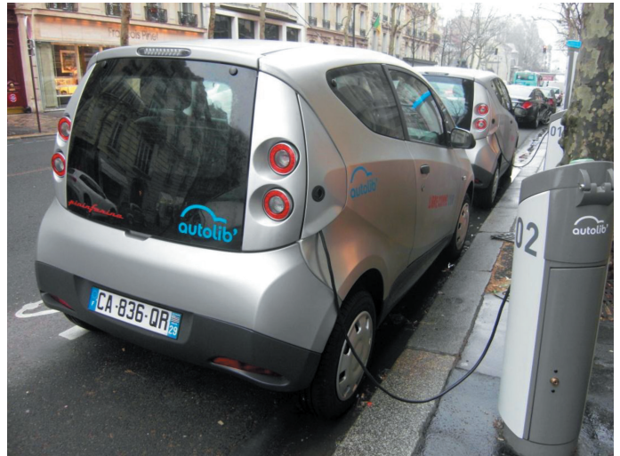
Fot. 1. Stacja ładowania baterii systemu Autolib w Paryżu
