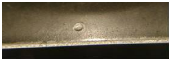
Fot. 2 Wgniecenie na powierzchni łopatki w okolicy krawędzi spływu
