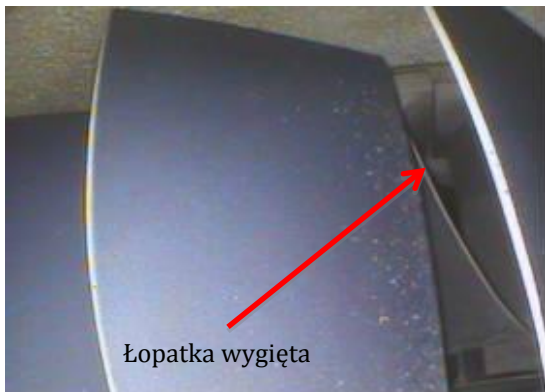
Fot. 6 Zgięcie łopatki u nasady
