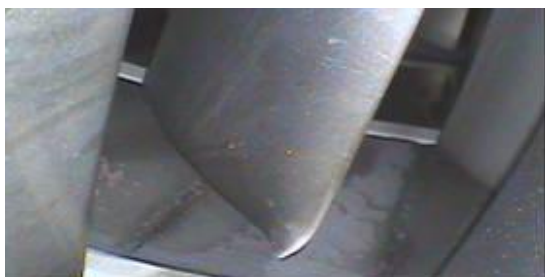
Fot. 5 Zagięcie końcówki łopatki sprężarki
