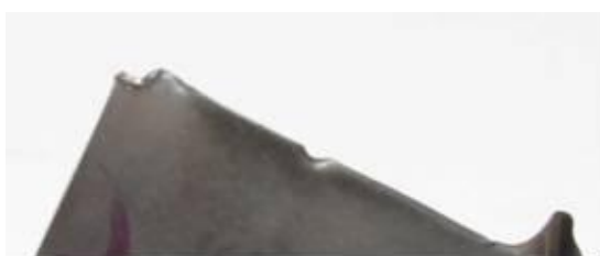
Fot. 4 Złamanie łopatki sprężarki, zbiecie krawędzi natarcia
