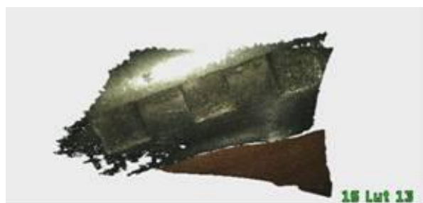
Fot. 13 Chmura punktów tworząca trójwymiarowy obraz elementu badanego i uszkodzenia
