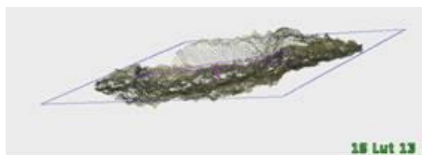
Fot. 14 Chmura punktów tworząca trójwymiarowy profil uszkodzenia
