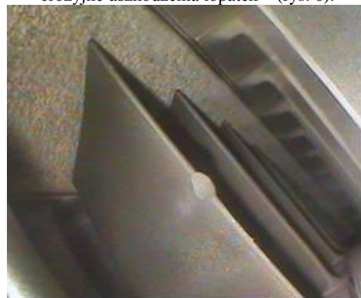
Fot. 1 Zbitie krawędzi natarcia łopatki sprężarki
