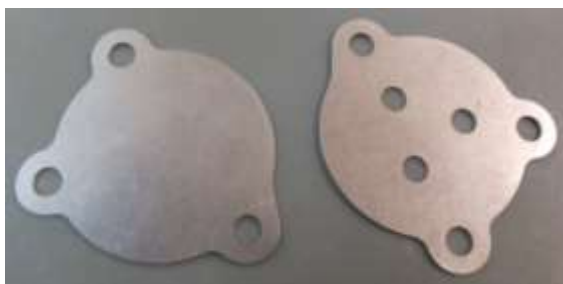
Rys. 6. Uszczelki do zmiany poziomu recyrkulacji spalin
