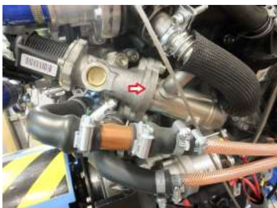
Rys. 5. Miejsce mocowania uszczelki do zmiany poziomu recyrkulacji spalin
