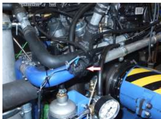
Rys. 8. Dodatkowy zawór elektropneumatyczny kontroli doładowania: strzałką oznaczono dodatkowy zawór elektropneumatyczny
