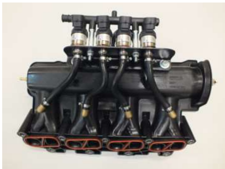
Rys. 2. Kolektor dolotowy silnika Fiat 1.3 MJT z wtryskiwaczami gazu (kolektor przed montażem)
