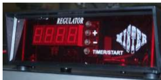
Rys. 7. Sterownik PWM do kontroli ciśnienia doładowania
