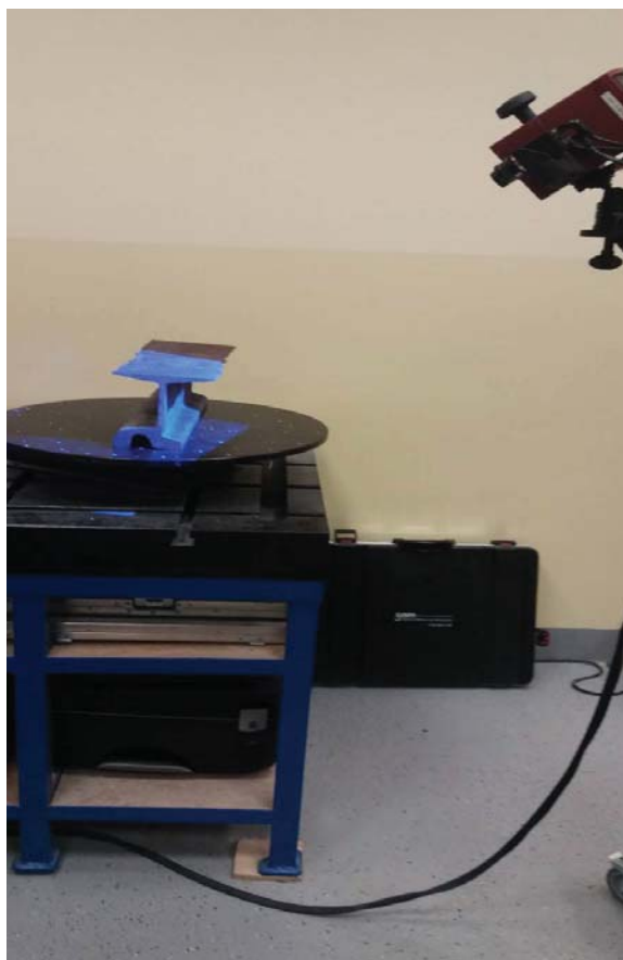
Rys. 19. Stanowisko do skanowania powierzchni ze stołem obrotowym; kamera na przesuwным statywie oraz szyna rowkowa na stole obrotowym ustawiona stopką do góry w czasie jej skanowania – obszar aktualnie obrabiany jest oświetlony niebieskim światłem
