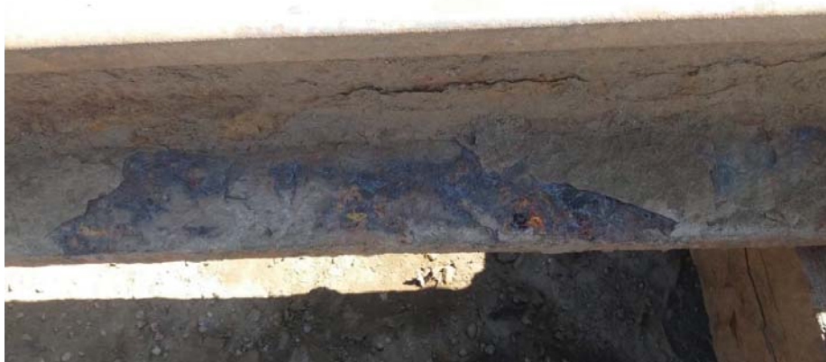
Rys. 16. Fragment szyny ze strefy katodowej po mechanicznym oczyszczeniu ukazujący poziom zmian geometrii powierzchni stopki i szyjki szyny wywołanych procesami elektrochemicznymi oraz odsłonięty do rdzennego metalu szyny fragment stopki
