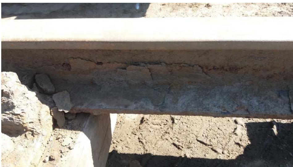
Rys. 15. Fragment szyny ze strefy katodowej po mechanicznym oczyszczeniu ukazujący poziom zmian geometrii powierzchni stopki i szyjki szyny wywołanych procesami elektrochemicznymi
