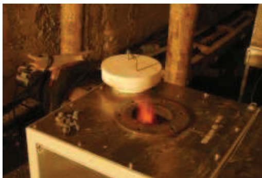
Rys. 17. Pianka typu Ekoflex w podczas testu palenia wysokotemperaturowego [opracowanie własne] Fig. 17. Foam of the Ekoflex type during the test of the high-temperature burning [own study]
