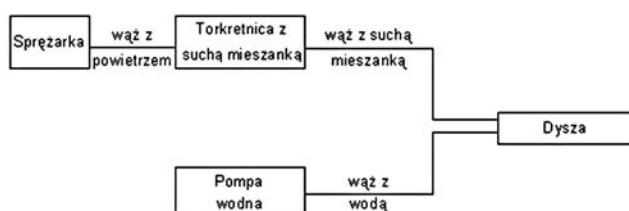
Rys. 3. Metoda mokra torkretowania
