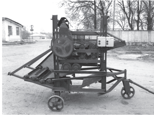
Fot. 2. Widok ogólny separatora lnianej masy omlotowej Photo 2. General view of separator for flax threshed mass
