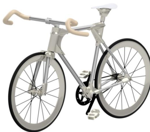
Rys. 3. Model roweru, którego rama składa się z kształtowników i uniwersalnych łączników.
