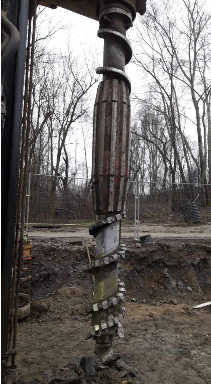
Rys. 5.1. Świder IMB Injection Displacement Pile (w skrócie IMBDP) do wykonywania pali przemieszczeniowych [10]
