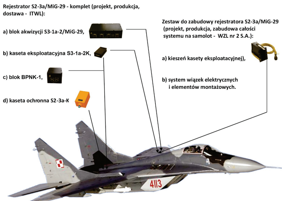
Rys. 4. Schemat sposobu zabudowy rejestratora S2-3a na samolocie MiG-29
