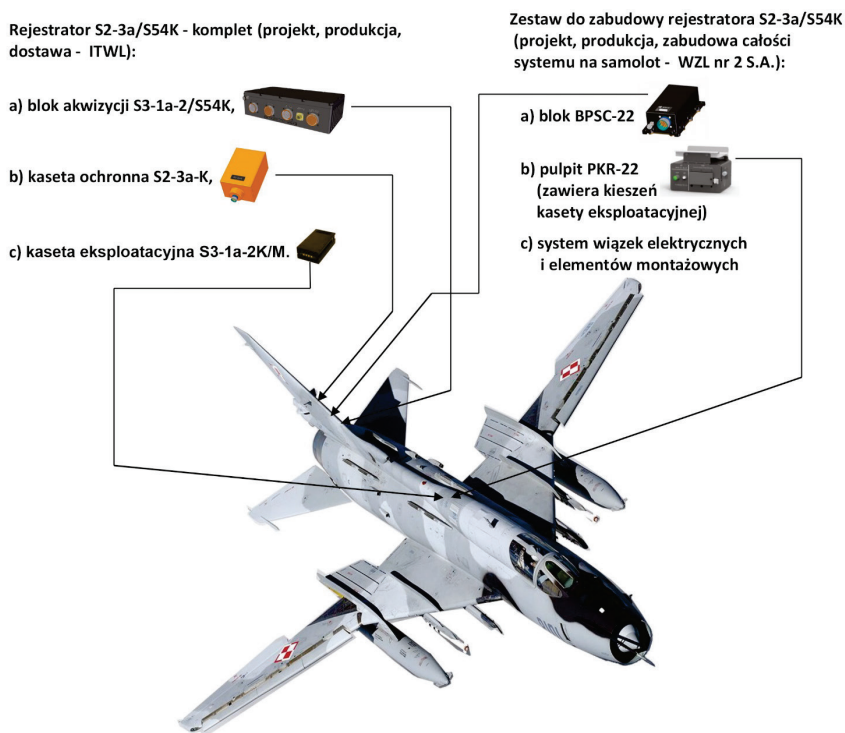
Rys. 5. Schemat sposobu zabudowy rejestratora S2-3a na samolocie Su-22M4
