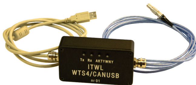
Rys. 7. Widok interfejsu WTS4/CAN USB do obsługi systemu rejestracji S2-3a [13]
