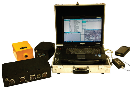
Rys. 3. Elementy systemu rejestracji parametrów lotu S2-3a z testerem WTS-5 [13]
