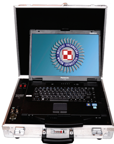
Rys. 8. Tester WTS-5 do skalowania i deszyfracji danych z rejestratorów S2-3a [13]
